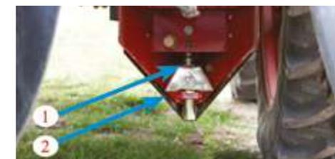
Рис. 2. Распределительное устройство в сошнике: 1 — тукопровод, 2 — распределительное устройство
