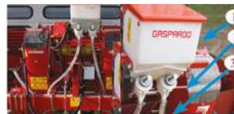
Рис. 1. Емкость для гранулята: 1 — емкость (бак) для гранулята, 2 — регулируемые катушки дозирующего аппарата, 3 — тукопровод
